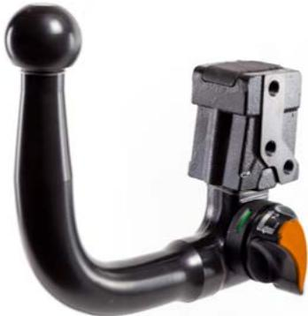
Questa tipologia di terminale fa sì che l'**impatto estetico dell'installazione del gancio sia il minore possibile**, e nella maggior parte dei casi completamente non visibile, conservando così una perfetta estetica del veicolo. Come per il terminale, la **connessione elettrica rimane nascosta dietro il paraurti** nella quasi totalità dei casi, ed è basculante quando necessaria.
