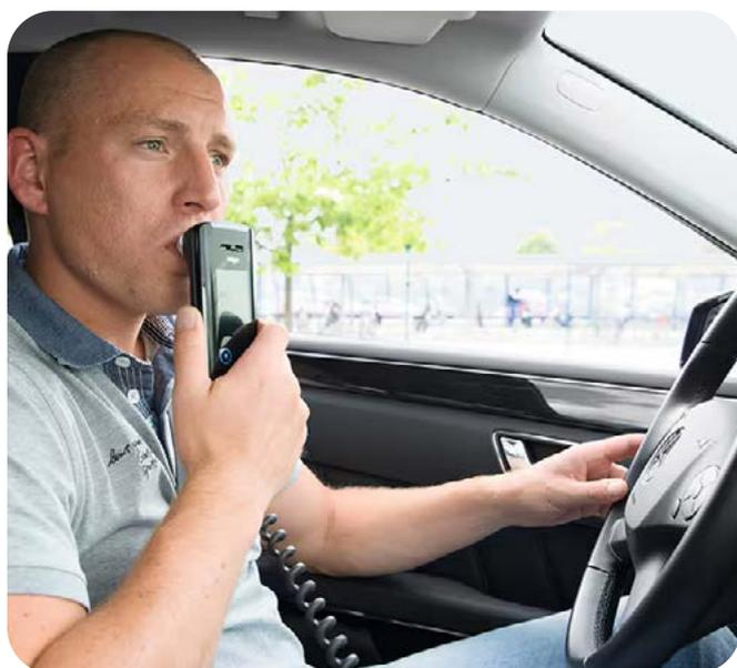
Il Dräger Interlock 7500 è un dispositivo per veicoli che blocca l'accensione se il conducente supera un limite alcolemico preimpostato. È composto da un **etilometro** per misurare il tasso alcolemico e una **centralina** che controlla l'avviamento del veicolo.
